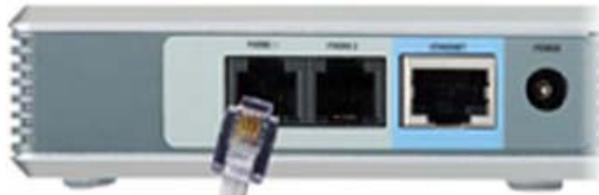
B) Conecte el cable Ethernet en el puerto etiquetado como "Ethernet Port" para comunicar el PAP2 con su dispositivo Router o su conexión de Internet.
